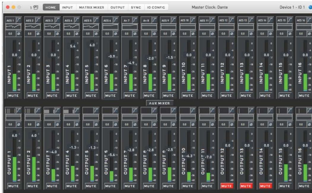
Als Beispiel einer klassischen Newton Home-Bildschirm-Oberfläche. Hier kann der Nutzer extrem schnell und direkt auf alle zu kontrollierenden Parameter (Eingangssektion, Signal-Generator, Equalizer, Delay, Polarität, Pegel, Mute, Matrix, Ausgangszuweisung und Clock-Management) zurückgreifen.
