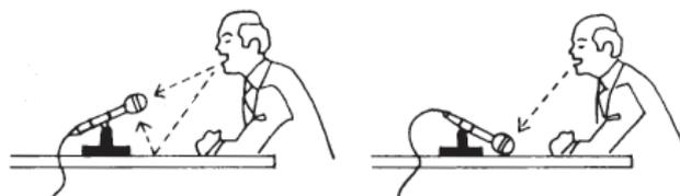
Auch bei Rednerpulten können Reflexionen bei falscher Mikrofon-Positionierung zu einem Problem werden. Hier sind mehrere Maßnahmen sinnvoll:
