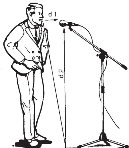
(25 cm : 250 cm = zehnfach) verliert das Signal ca. 20 dB SPL. Hinzu kommt die Dämpfung an der reflektierenden Oberfläche (Absorption). Wird ein gerichtetes Mikrofon verwendet, wird die Reflexion nochmals um mindestens 3 dB gedämpft.
